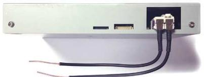
GPS антenna должна быть установлена в подпанельное пространство, не должна устанавливаться на магнитолу и кабель не должен быть скручен в кольцо. Если автомобиль имеет обогрев лобового стекла, то антенну необходимо устанавливать на правую стойку или левую стойку, в месте, где отсутствует обогрев.
