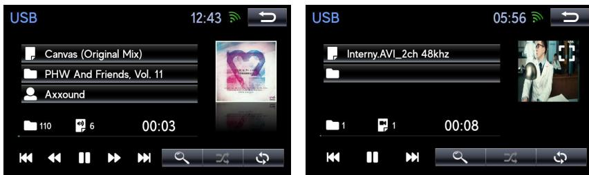
При извлечении **USB** носителя, система закроет плеер автоматически. При повторном подключении того же носителя, при условии, что носитель не менялся, устройство возобновляет воспроизведение аудио контента с места остановки воспроизведения в момент извлечения съемного носителя.
