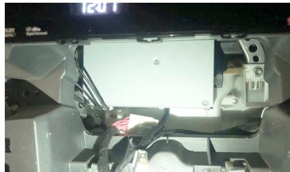
Для **GX 460** блок ставится вертикально за экраном. Для **LX 570** можно использовать наиболее удобный из вышеперечисленных мест установки.
