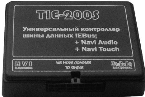
*Функциональное назначение:* Данное устройство обеспечивает передачу координат, соответствующих месту нажатия оригинального «тачскрина» автомобилей Toyota, как навигационному устройству (GVN53, PHANTOM, LM7200, Мирком), так и любому другому устройству, используя встроенный системный интерфейс. Обеспечивает интеграцию звука, формируемого дополнительным навигационным устройством, в штатную среду автомобиля. А также осуществляет управление коммутатором GVIF или RGBCs
