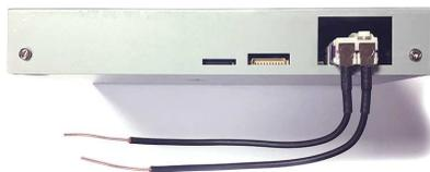
GPS антенна должна быть установлена в подпанельное пространство, не должна устанавливаться на магнитолу, а кабель не должен быть скручен в кольцо.
