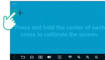
**Touch Calibration** – позволяет произвести калибровку сенсорного экрана. Для калибровки сенсорного экрана необходимо нажать и удерживать палец на
