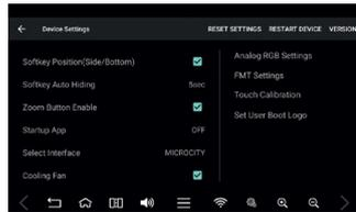
**Cooling Fan** – позволяет включать и выключать режим автоматического запуска принудительного воздушного охлаждения блока AirTouch Performance.
