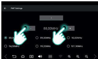
Далее настройте FM-транسمиттер на незанятую частоту (список незанятых частот уточняйте для своего региона) при помощи кнопок **+** и **-** меню “FMT Settings”. Включите штатный радиоприемник своего автомобиля и настройте ту же частоту радио, которая была настроена в настройках
